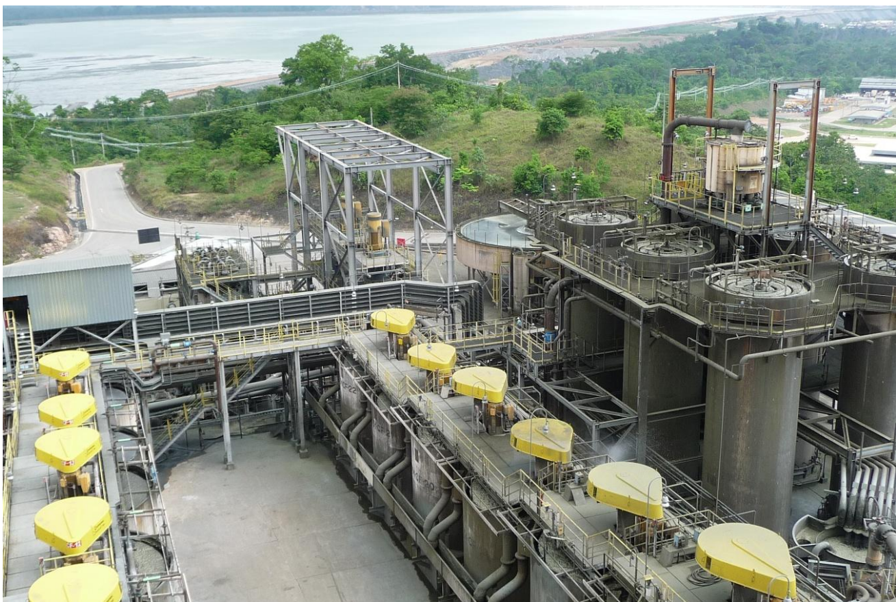
Figura 21: Circuitos de Flotación Sossego
