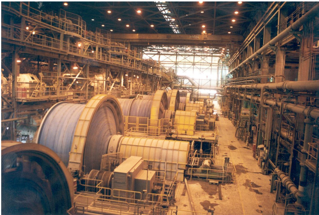
Figura 34: Molinos SAG y Molinos de Bolas en configuración “side by side” de Los Colorados
